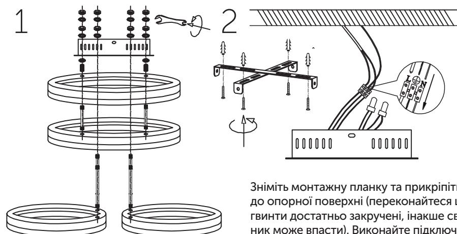
Зніміть монтажну планку та прикріпіть її до опорної поверхні (переконайтесь що гвинти достатньо закрученні, інакше світильник може впасті). Виконайте підключення світильника до мережі живлення (мал. 2).
